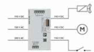
Motorer, afbrydere eller magnetventiler – med QUINT Power forsynes belastninger op til 135 V DC sikkert
