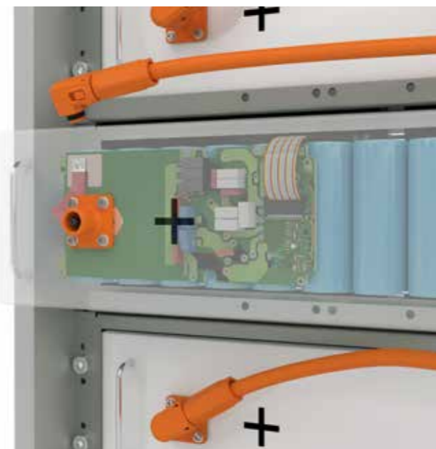
Overblik over et energilagringssystem med batteripakker, BMS printkort og interne og eksterne interfaces
