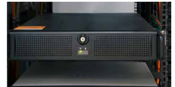
19" rack varianten af den pladsbesparende industri-pc med to rackenheder (RU), hvorpå IRMA sikkerhedssoftwaren er installeret
