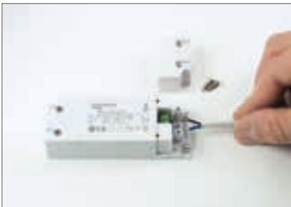
Trin 1: Fjern skruerne fra dækslet og forbindelseskabler
